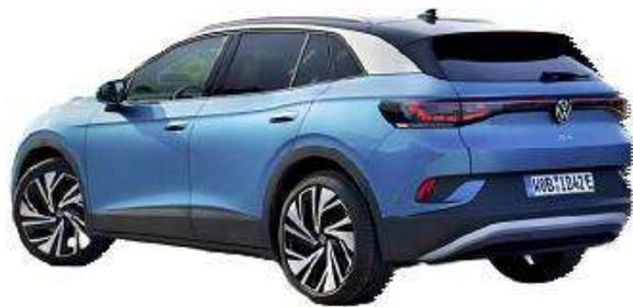
機能面を最初に決め、そこにボディをかぶせていったような構成のVW ID.4。EV専用のMEBプラットフォームで数モデルを作り分けているが、日本で販売されているのはID.4のみ。サイズはCセグメント+と大型。
