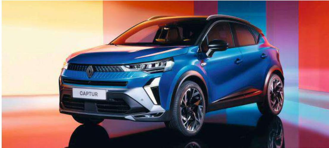
●新グレードは上級のエスプリ アルピーヌ（フルハイブリッドとMHEV）とベーシックなテクノ（MHEVのみ）の2種類。フルハイブリッドは自然吸気エンジン（94ps）と2基のモーター（49psと20ps）によって前輪を駆動。MHEVはターボエンジン（158ps）にBSG（5ps）を追加している。
