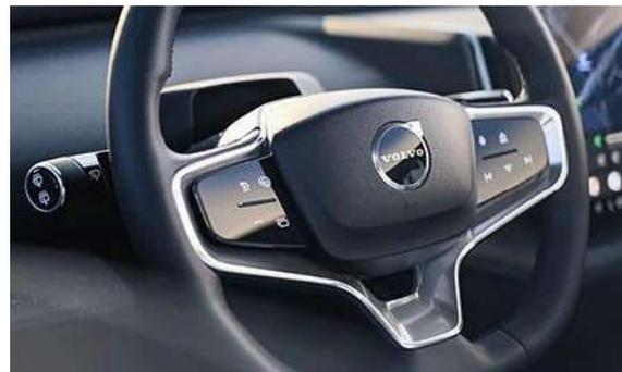
若干角ばったステアリングだが操作性は悪くない。左右のスポーク上のスイッチ類も直観的に扱える。ドライバーの正面、ステアリングコラム上にはメーターではなくドライバーモニタリングシステムのセンサーが付いている。
