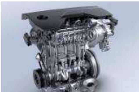
1.2ℓ直3ターボエンジンは可変ジオメトリー・ターボチャージャーとミラーサイクルで高効率化するとともに、ハイブリッドへの最適化を図るために4割もの部品を新設計した新世代ユニット。高効率高性能なガソリン可変バルブタイミングシステムを実装し、136馬力を発生する。
