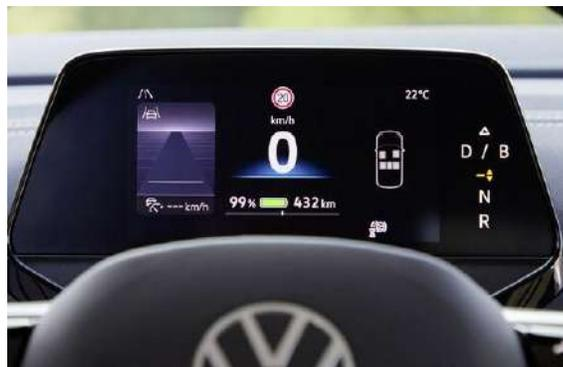
ステアリング越しのメーターパネルは最小限の大きさだが必要な情報はしっかりと盛り込まれ、ICEモデルのVWから乗り換えても違和感がない。
