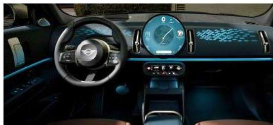
ドライバーの正面はヘッドアップディスプレイのみ。物理メーターはなくなっている。ステアリング上やセンターコンソールからも物理スイッチをできるだけ排除しシンプルなデザインを強調。ダッシュボード全体にざっくりしたリサイクルポリエステル製のジャージ生地を使い、走行モード連動のカラフルなライトを投影し遊び心をアピール。
