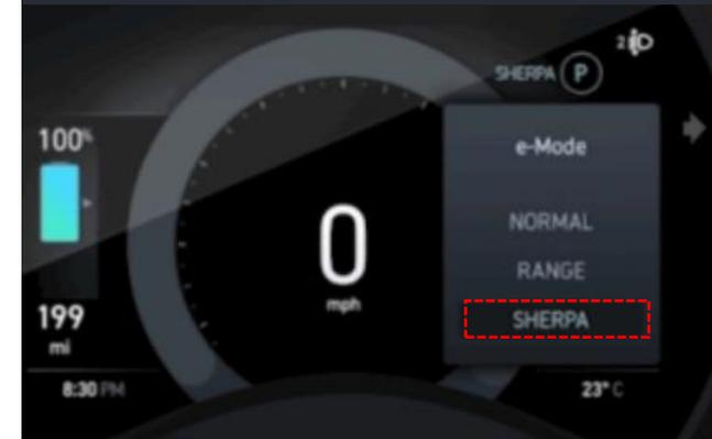
長距離走行を実現するモード。時速80km以下で走行するとともに消費電力を抑制するために、アクセルレスポンスの調整やエアコンやシートヒーターなどは自動的にオフに。手動でエアコンなどは再起動できる。
