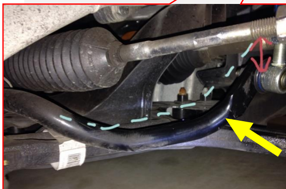
マクファーソンストラット (スタビライザー付き) ※画像はアバルト595
